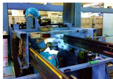
ケース移載機 点検風景
