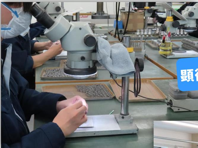
顕微鏡を使用し研磨します。
