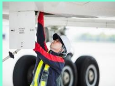
給水・排水作業
