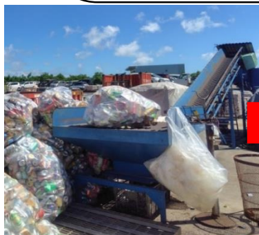
空き缶をブロック状に圧縮するマシン
