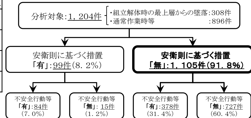
図 安衛則に基づく墜落防止措置の実施状況
