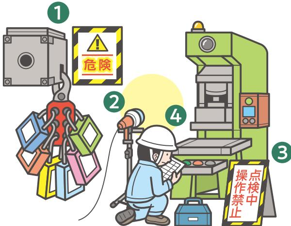
① 起動スイッチ等に施錠。（参考／グループロックアウト方式：複数人がキーを持ち、全員のキーが揃わなければ機械が起動しない方法）
