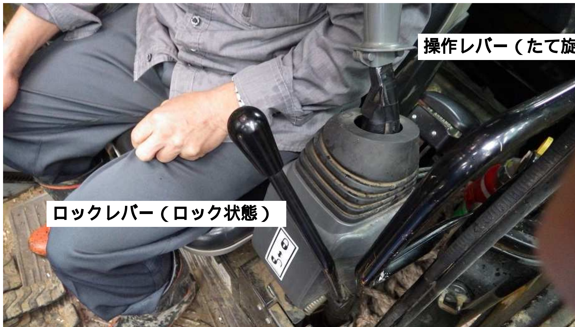
運転席のロックレバーと操作レバーの配置状況
