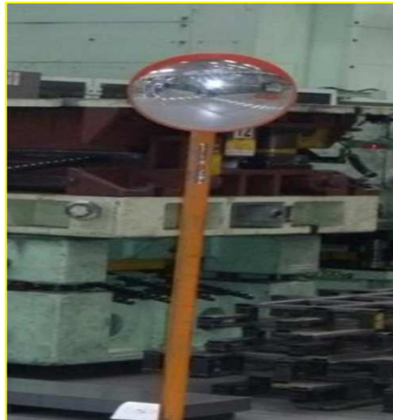
工場内の通路の交差点で、安全確認をするミラーを設置している
