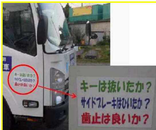
トラックの車体に確認事項を貼付している
