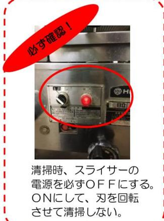
清掃時、スライサーの電源を必ずOFFにする。ONにして、刃を回転させて清掃しない。
