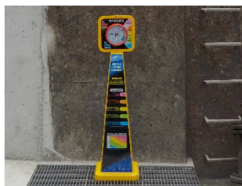
熱中症注意計 【梅林建設株式会社 建設工事現場】
