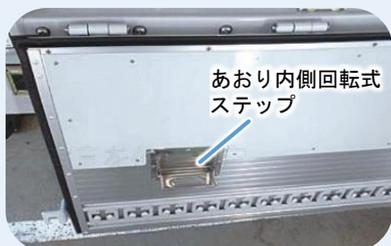
床面と荷台との間、床面と荷の上との間の昇降のために設ける昇降設備には、踏み台等の可搬式のもののほか、貨物自動車に設置されている昇降用のステップ等を含むため、ご質問の「あおり内側回転式ステップ」も含まれます。
