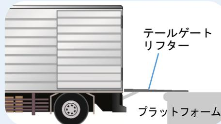
特別教育の対象となる「テールゲートリフターの操作の業務」には、テールゲートリフターの稼働スイッチを操作することのほか、テールゲートリフターに備え付けられたキャストーストッパー等の操作、昇降板の展開や格納の操作等が含まれます。
