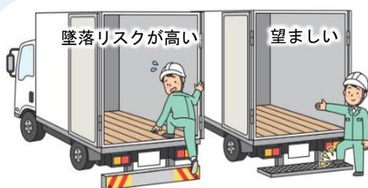
突出していないもの（上から見たときにステップが見えない等）は墜落・転落するリスクが高いため、より安全な設備を設置してください。
