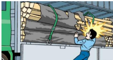
固定ベルトを外した途端に木材が落下
