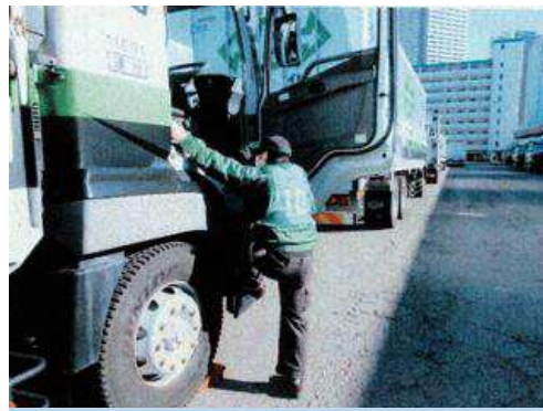
墜落・転落防止：三点支持の徹底
