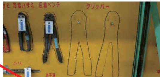
数多い手動工具に対し、収納位置を決め、工具の紛失、持ち出し管理、効率を含め、4S向上を図った。また、持ち出し時は、対象工具のプレートを個人フックに掛け、使用者を「見える化」している。
