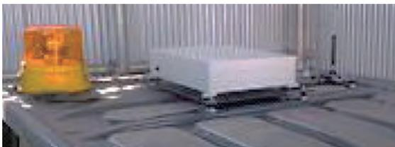
フォークリフトと建設機械の可動範囲が重複しており、接触災害の危険があるため双方に接近を警告する近接検知センサーを導入し、死角外の危険も認識できるようにした。
