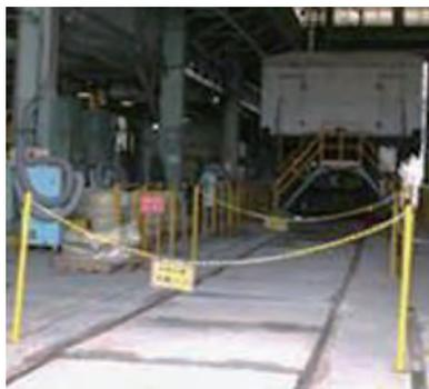
玉掛けエリアを明示し、玉掛け作業は必ずエリア内で行うこととしている。
