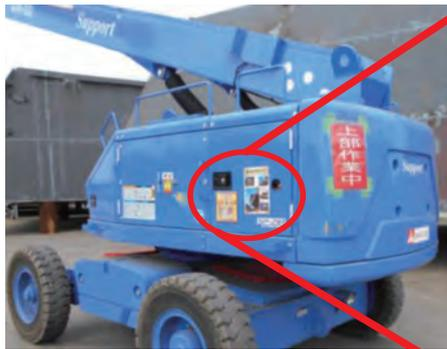
高所作業車を使用する作業員に対して、資格証の携帯等、作業の安全ルールについて表示している。
