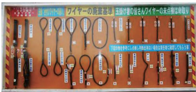
月例点検時に点検箇所や廃棄基準が一目でわかるよう、交換の必要なワイヤロープを展示している。
