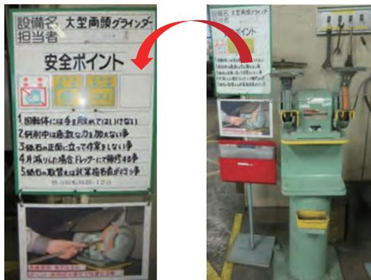
設備毎に安全ポイントと装着保護具、危険要因を記載した写真を掲示し、作業者に対し設備使用前に安全項目を確認させる。
