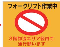
フォークリフトと通行者の接触を防ぐため、フォークリフト作業を行っている際は、作業中及び作業域の通路に通行禁止の注意を掲示している。
