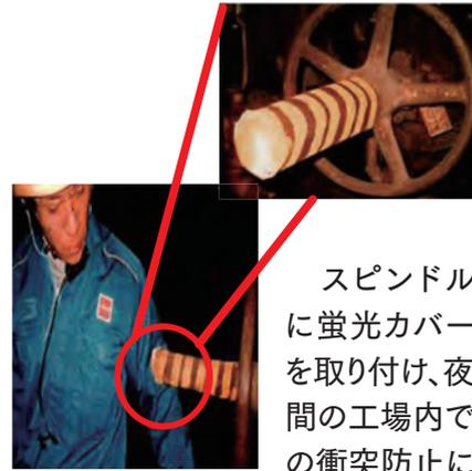
スピンドルに蛍光カバーを取り付け、夜間の工場内での衝突防止に努めている。
