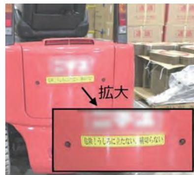
フォークリフト後退時には視角が狭くなるため、接触等のリスクが高い。リスクを減少させる為に『見える化』で注意喚起している。
