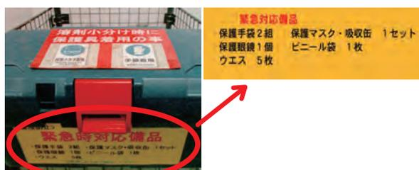
溶剤の運転台車に緊急時対応備品を装備し、内容を明示するとともに、作業時の保護具着用の注意事項を明示している。
