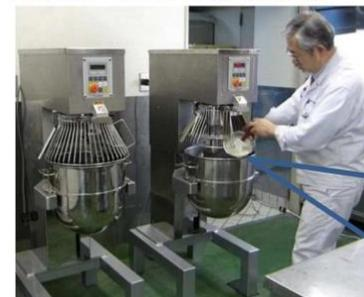
インターロック機構（可動式覆いを閉じないと回転部が動かない機能）を有するミキサーの事例
