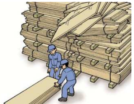
木材半加工品の倉庫においてツキ板の検品を行っているときに発生した死亡災害
