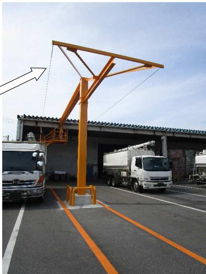
倉庫内から階段を使用し、この場所から墜落制止抑止用器具を取り付けてトラック上部に上がり除雪する
