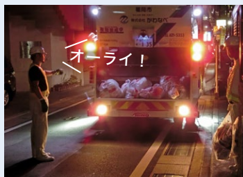
後方の状況を確認しながら作業者が発声する
