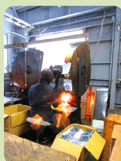
大型のプレス機でフライ返し の穴の部分の打ち抜いています
