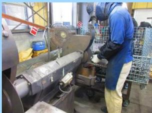
⑤バリ取り(切り離れたところの金属の凸凹など)を行い、製品を仕上げていきます。大きな部品、表面などは機械で削り、小さな部品や内側などはペンシル型の機械で、削り綺麗に仕上げていきます。
