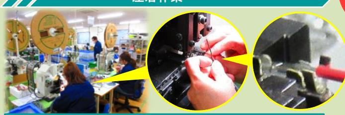
先端を1本1本加工機にのせて、足踏み操作で端子を付けます。
