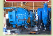
熱処理を行う機械に製品を並べて、 ボタン操作し、加工後の製品を取り出 す作業です。
