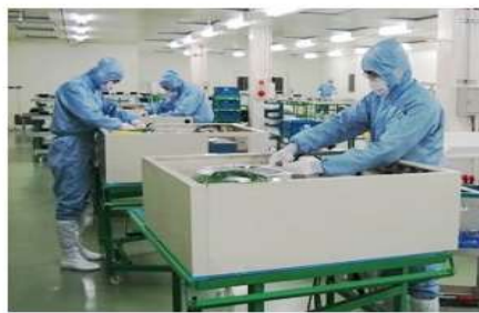
フィルタユニット組立用クリーンルーム
