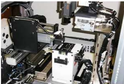
絶縁監視装置検査ライン
