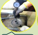
内径を測っています。計 測器を差し込むと目盛り で表示されます。
