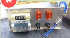
部品をはめて、工具でねじ止めをしたりして組み立てます
