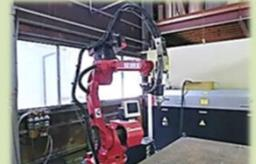
YAGレーザー溶接機
