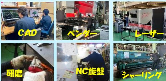
お客様からオーダーが入ると、設計図を作成、各種加工機や、道具を用いて切断・溶接・切削等を行い、仕上げていきます。機械の操作など、わからないことがあれば先輩社員が指導します。時間をかけて技術を磨きあげていきます。
