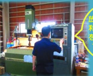
放電による熱を利用し、工作物を溶かして加工する方法です
