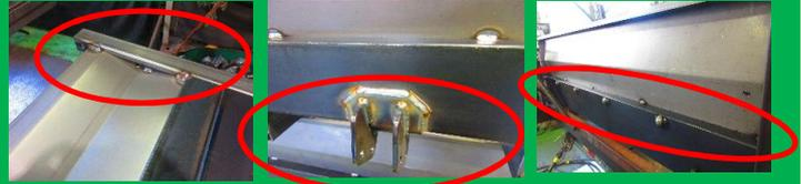
金属の材料をセットし、溶接・組立します。材料も大型になるので、ロボットではなく手作業で溶接していきます。
