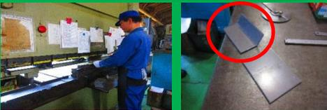
部品を作るため、材料をセットして曲げ加工をします。
