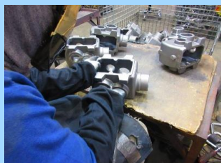
⑤バリ取り(切り離したところの金属の凸凹など)を行い、製品を仕上げていきます。大きな部品、表面などは機械で削り、小さな部品や内側などはペンシル型の機械で、削り綺麗に仕上げていきます。
