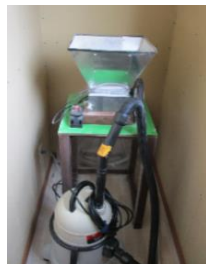
麦芽の粉碎器。調整は機械制御されている
