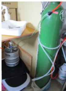
この段階で炭酸ガスを注入
