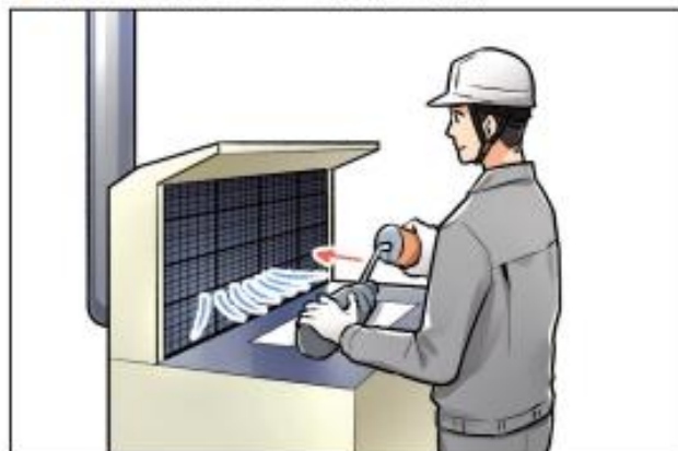
① 局所排気装置等の設備の稼働
