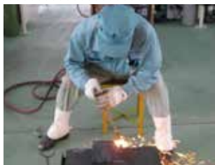
ガス切断作業
