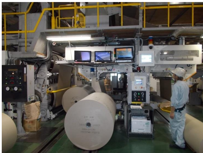
巻取り紙を貼り合わせ、 段ボールシートを製造することから始まります。
