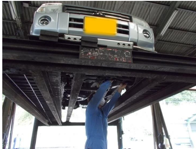
足回りの点検中
