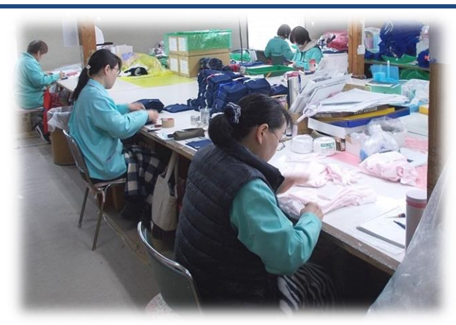
検品 入念にチェックし、更に機械でも異物検査をしてから出荷します
