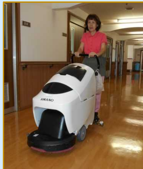
自動床洗浄機 「クリーンバーニー」 押すだけでらくらくモップ掛け
