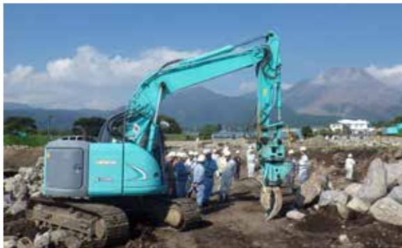
災害が発生している「クレーン機能付きドラグショベル」を用いた「吊荷の 1 本吊り作業」について、安全対策を当署安全衛生係長が説明。
