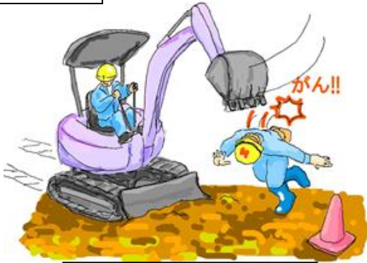
重機移動中の人払いなし
