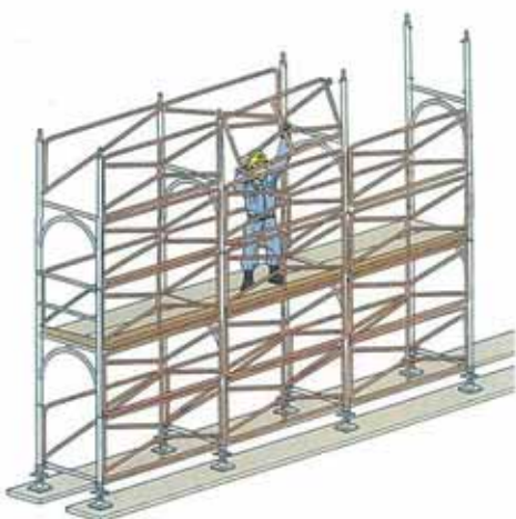
わく組足場の手すり先行専用足場方式
