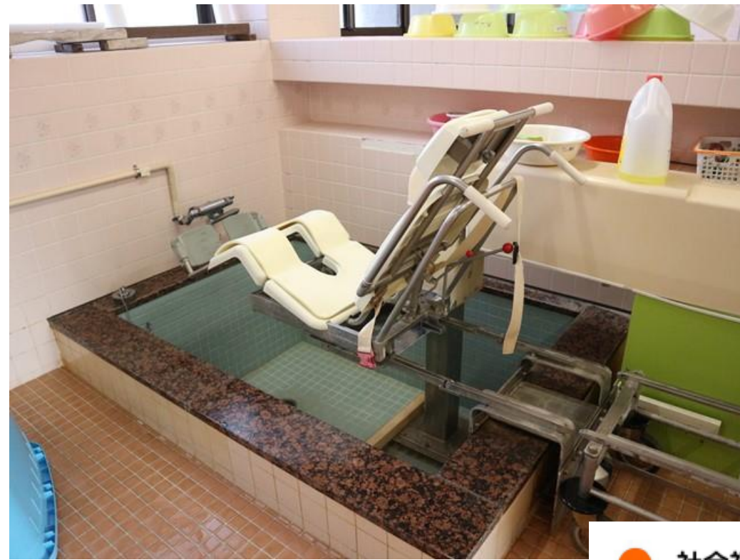
②前方へスライドし、下降する構造
