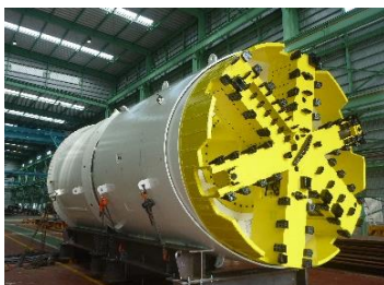
シールド掘進機 土の中を横方向に掘り進める機械
