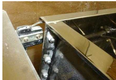
蓋を開けた状態ではインターロック機構が作動し、機械が停止する
