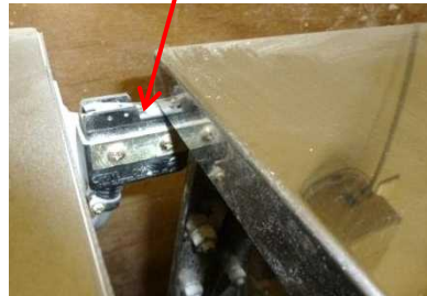
蓋を開けた状態ではインターロック機構が作動し、機械が停止する
