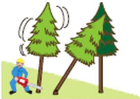
(図4) かかり木に激突させるためにかかり木以外の立木を伐倒 (浴びせ倒し)
