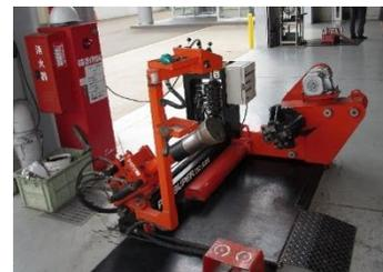
大型トラック・バスなどの大口径タイヤの組替・脱着に使用する専用機械
