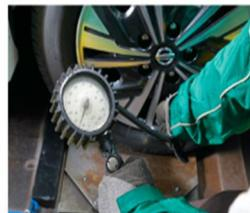
タイヤ点検・タイヤ空気圧充填
