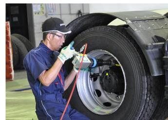
大型トラックのタイヤを専用インパクトレンチで脱着します。
