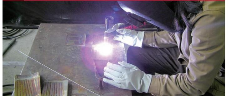
ステンレス鋼・アルミニウム合金のTIG溶接に関する技能及び関連知識を習得します。
