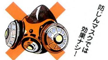
CO発生機材は、空気中の酸素を使用して燃焼等をする機材であり、空気中の酸素濃度が低下する可能性があることを考慮して正しい呼吸用保護具を選定しましょう！
