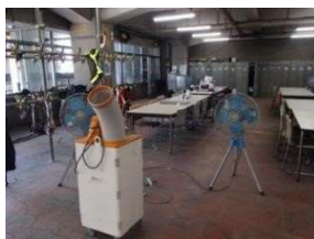
【写真 17】業務用扇風機・スポットクーラーを設置
