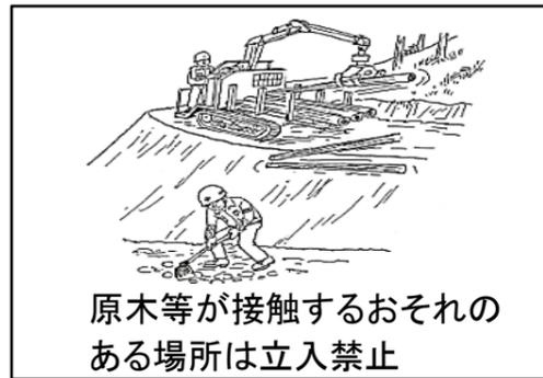
平成30年に県内において、ハーベスタの集材ウインチ等で集材中、伐倒木が転がり落ち、斜面したにいた荷かけ者に激突する死亡事故が発生しています。
