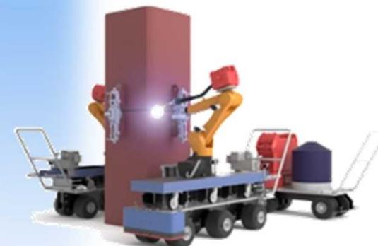
鉄骨溶接ロボット
