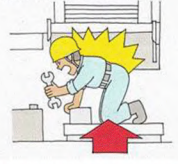
加熱機械の調整作業を行っていたところ、電源を切っていないため、加熱機械にはさまれた
